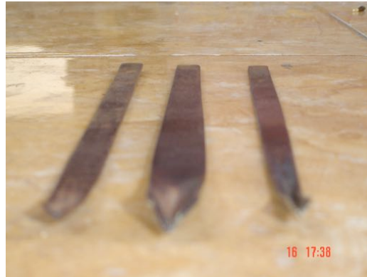
Pahat penyisiran dengan mata pahat bentuk "V" (Radiawan 16 Des 2006)
