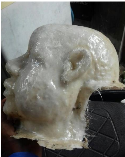
Gambar 3.7 Hasil Wajah Wayang setelah Dicetak Menggunakan Fiberglass (Foto : Darma Putra, 2017)
