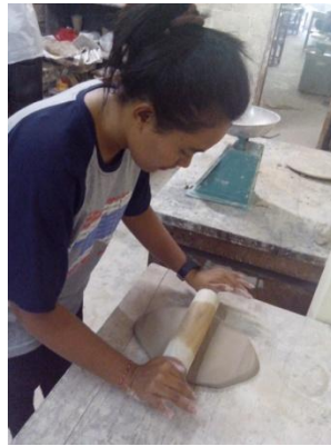
Proses Pemipihan Slab
