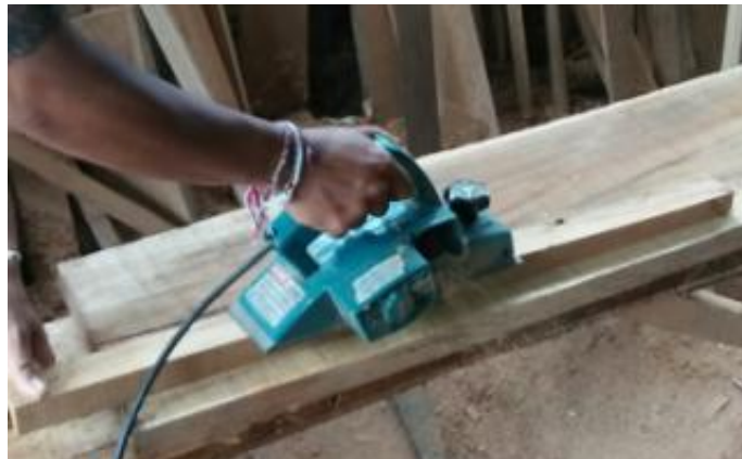
Gambar 3.28 Proses Penyerutan Foto: Penulis, 2016
