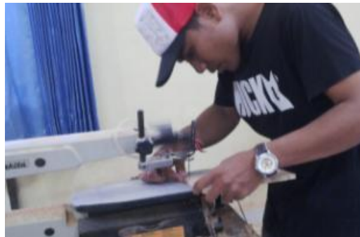
Proses melobangi menggunakan mesin jigsaw Foto: Penulis, 2016
