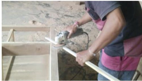
Penghalusan menggunakan amplas grinda Foto: Penulis, 2016
