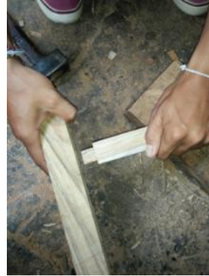
Proses membuat sambungan purus Foto: Penulis, 2016
