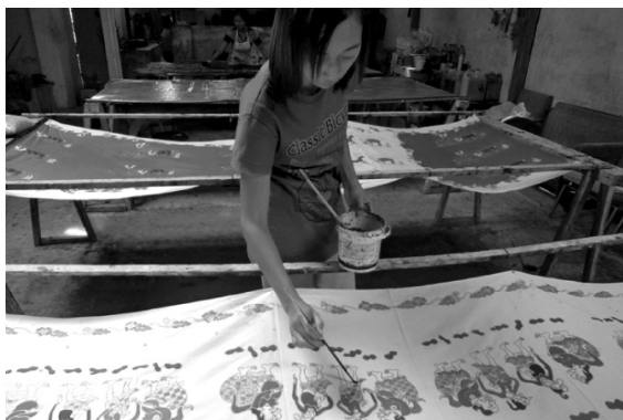
Gambar 4. Nolèt , untuk memberikan warna tertentu pada kain yang sudah dibatik (Sumber: Dokumen Foto Sugeng Nugroho).
