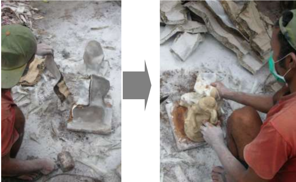
Pembongkaran cetakkan induk
