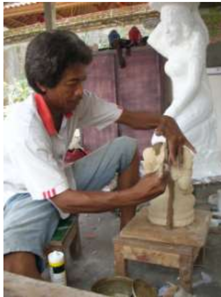
Gambar 5.1 Pembuatan sekat pada model (Dok. Sida Arsa, 2012)
