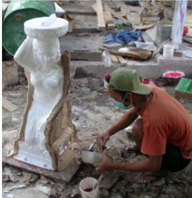
Gambar 5.4 Pembuatan cetakan induk dari fiber glass (Dok. Sida Arsa, 2012)
