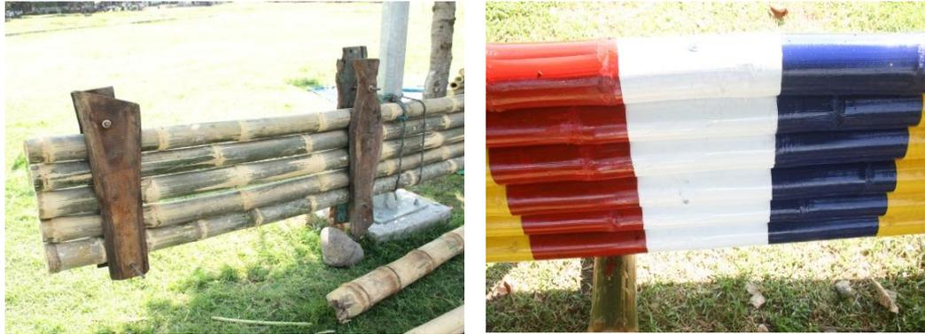
Gambar 6.12: Material Landangan yang terbuat dari Bambu Petung dan dilapisi warna primer (Dokumentasi : IGN. Indra Aryadi Tjahjadi)
