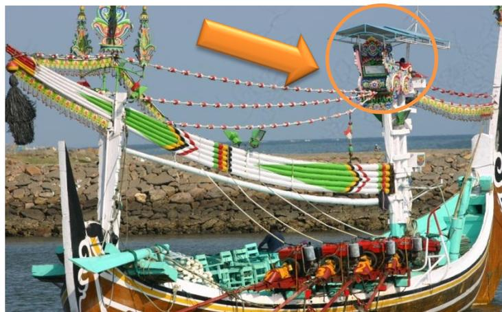
Gambar 6.6 Posisi Panggungan pada Perahu Slerek
