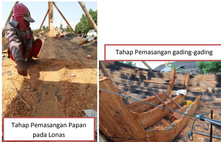
Gambar 4.5 Proses Pembuatan Perahu Slerek di desa Pengambengan
