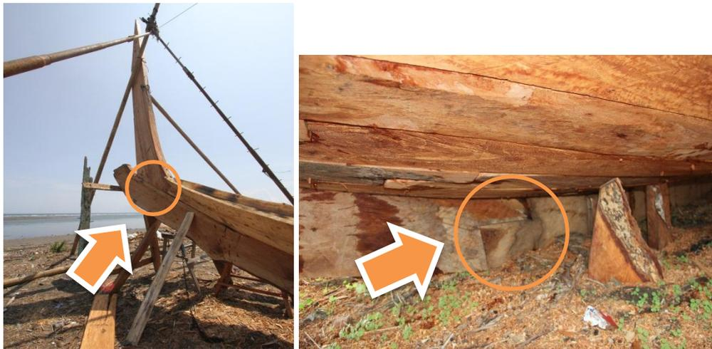
Gambar 5.2 Posisi sambungan *Lenggi* dengan *Lunas*
